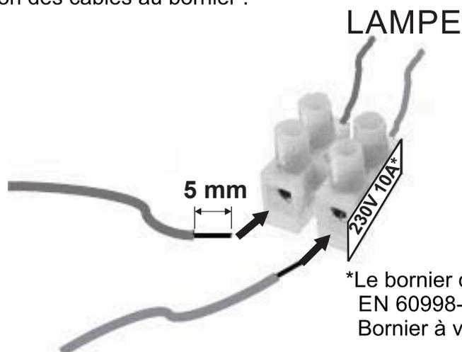
\*Le bornier doit être conforme aux normes EN 60998-2-1 et EN 60998-1:
