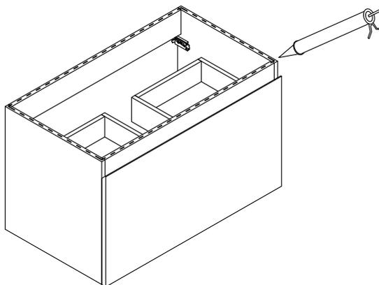
**Deuxième étape** : Appliquer un cordon de joint silicone régulier aux jonctions **plan vasque / caisson** et **plan vasque / mur**. Lisser au doigt ou à la spatule. Laisser sécher selon la durée adéquate (se référer aux données fournies par le fabricant sur la cartouche de silicone). **Ne pas mettre en eau durant cette phase de séchage.**
