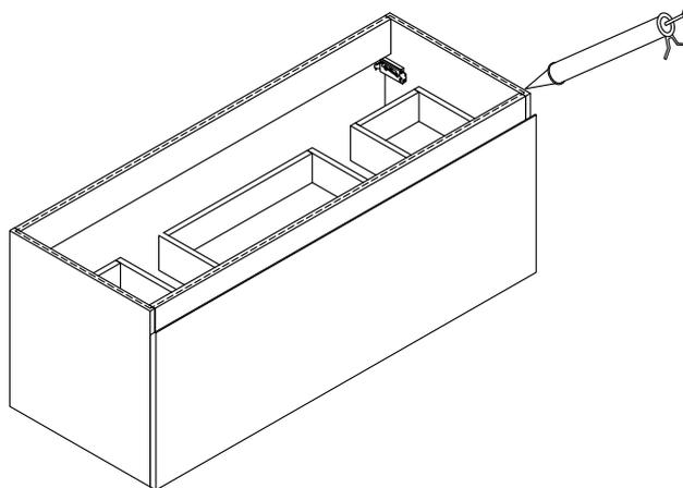
**Deuxième étape** : Appliquer un cordon de joint silicone régulier aux jonctions **plan vasque / caisson** et **plan vasque / mur**. Lisser au doigt ou à la spatule. Laisser sécher selon la durée adéquate (se référer aux données fournies par le fabricant sur la cartouche de silicone). **Ne pas mettre en eau durant cette phase de séchage.**
