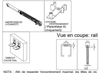
doivent avoir un Ø de 11mm max et une hauteur max de 4 mm (hors
