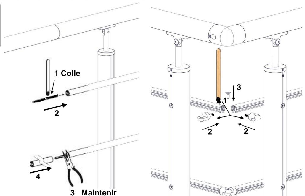
Mélanger puis appliquer la colle bi-composant grâce à la spatule prévue, maintenir la liaison à l'aide d'une pince lors de l'insertion de la lisse suivante.
