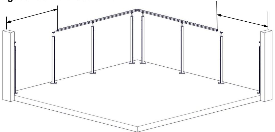
**!** Ne pas oublier un jeu mini de 20mm pour l'insertion des bouchons de main courante
