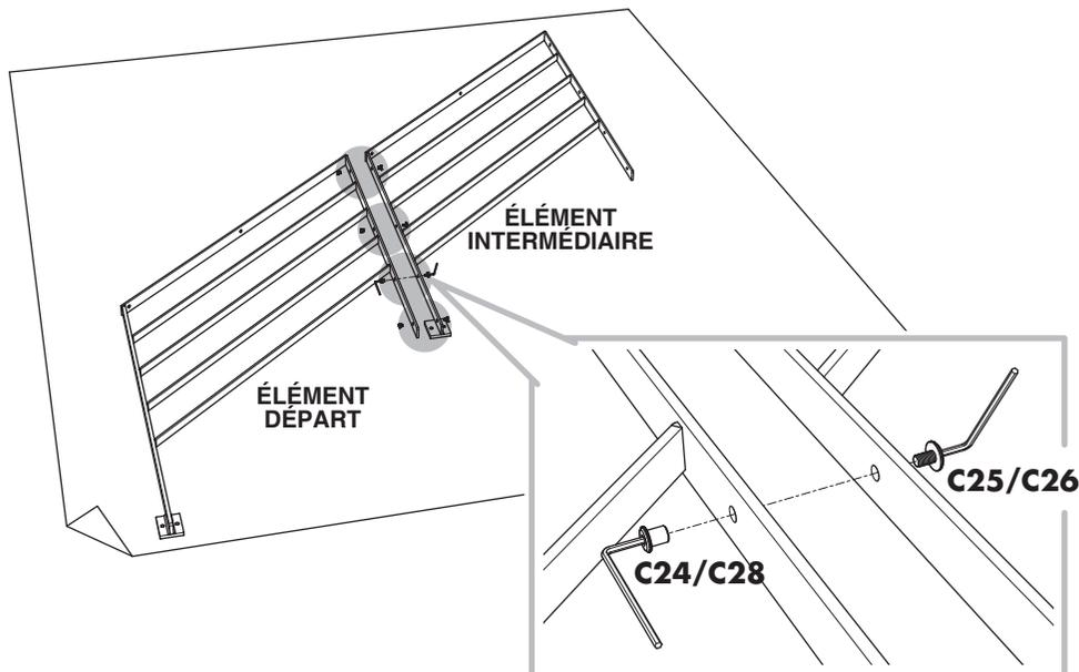
**2** Mise en place des vis et douilles de jonction éléments de rampe intermédiaires.
