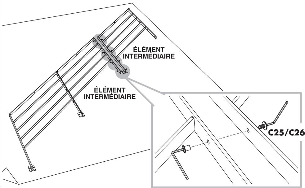
**3** Mise en place des vis et douilles de jonction élément de rampe arrivée.
