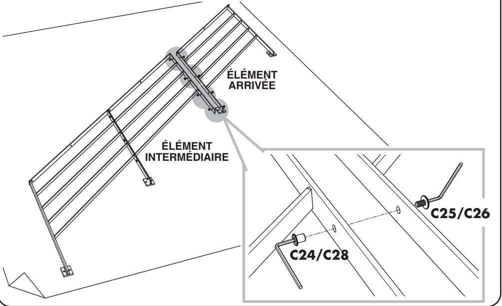
**4** Mise en place et vissage de l'ensemble de la rampe sur l'escalier.
