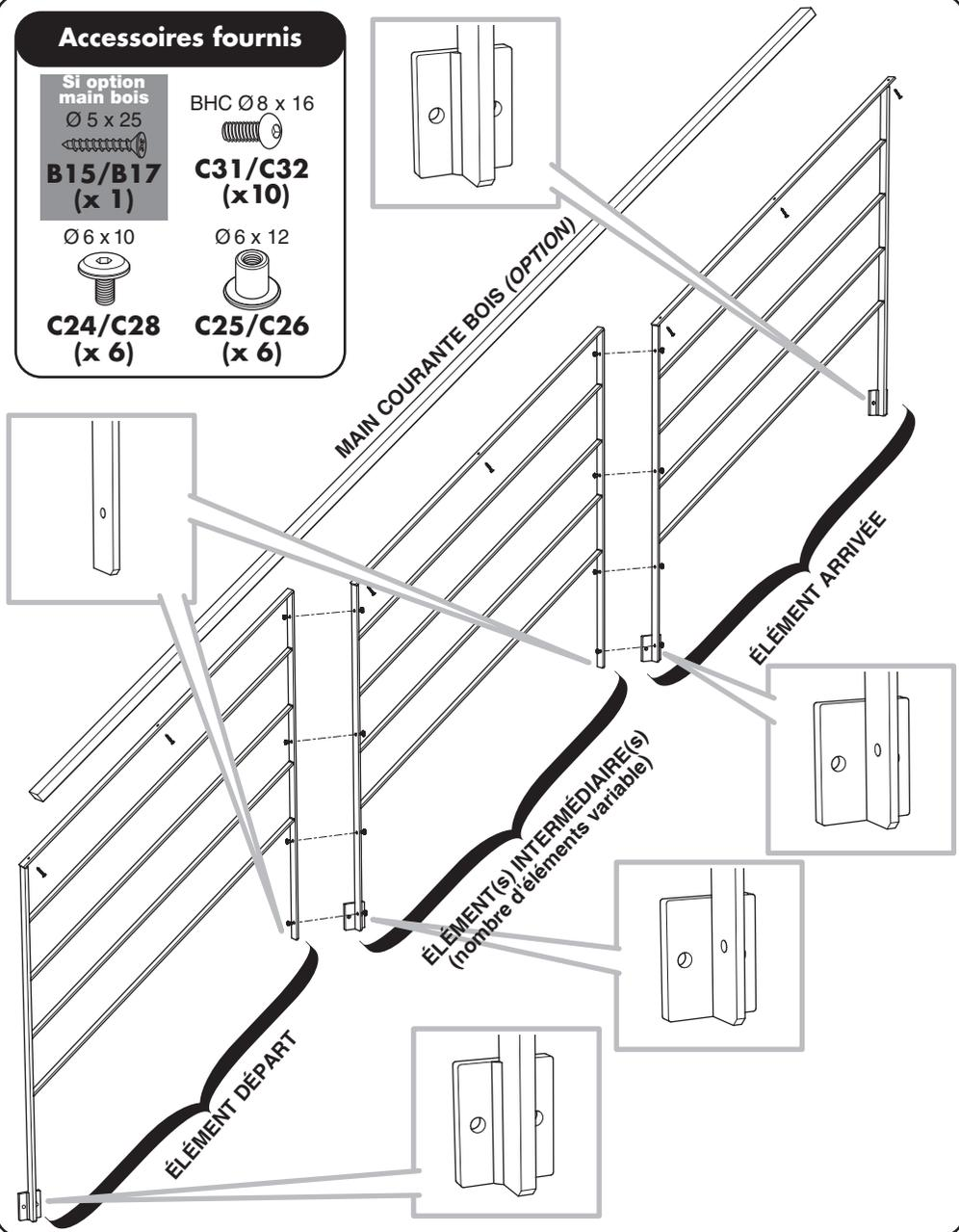
**1** Mise en place des vis et douilles de jonction élément de rampe départ.
