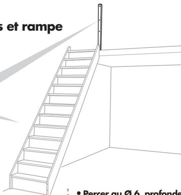
• Positionner le poteau d'arrivée sur le limon.
