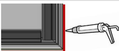
Appliquer un cordon de mastic silicone ou acrylique entre la cloison et la verrière.
