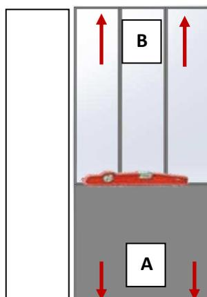
**2/ Mettre la cloison d'aplomb horizontalement.**
