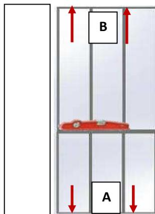
**2/ Mettre la cloison d'aplomb horizontalement.**
