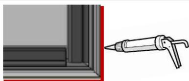
Appliquer un cordon de mastic silicone ou acrylique entre la cloison et la verrière. Existe en couleur.
