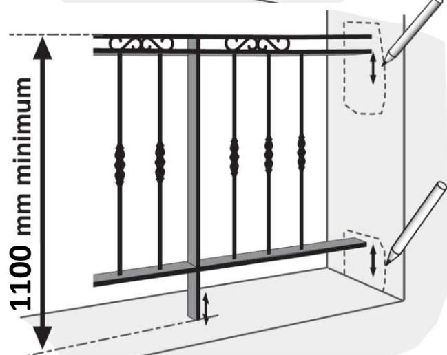
Effectuer un montage et une pose « à blanc » de l'ensemble pour marquer les positions des réserves à effectuer, en retirant la hauteur de scellement au sol.
