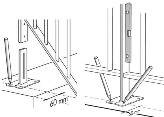
Pour certains modèles de rampes et les poteaux de départ et intermédiaire, les platines de fixation ne font pas partie intégrantes des montants et sont livrées à part.
