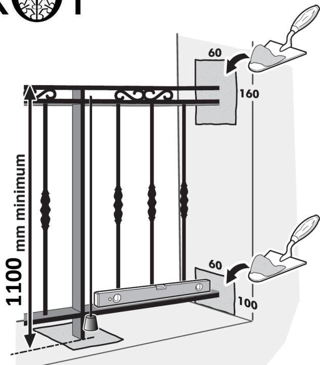
Mettre en place les éléments dans les réserves et sceller l'ensemble en contrôlant l'aplomb.
