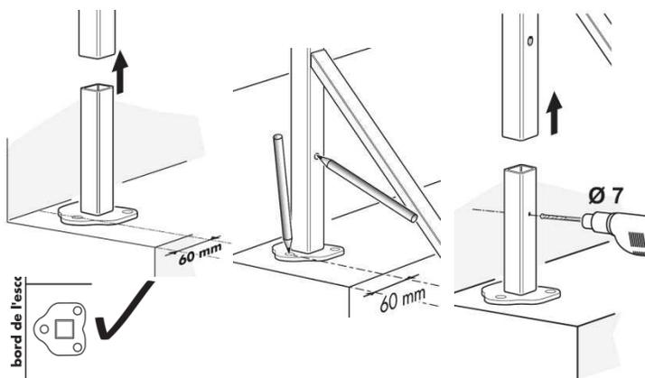
Il existe plusieurs modèles de platines non intégrées. Pour les platines tubulaires effectuer un repérage du perçage à réaliser, après avoir inséré le montant dessus.
