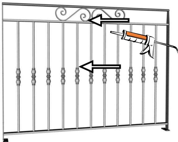
Pour éviter les points d'accumulation d'eau et donc empêcher une apparition de rouille, effectuer un joint silicone compatible avec de la peinture à chaque point de soudure et aux fixations des éléments décoratifs.
