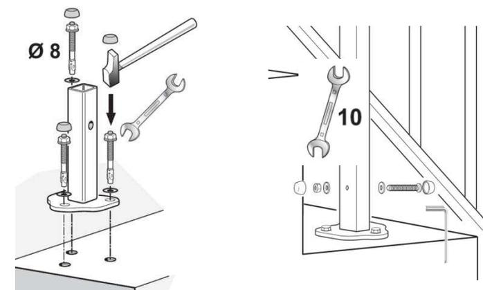
Remettre en place les éléments et et les fixer solidement au sol. Chaque platine doit être fixée au niveau de 3 points d'encrage avec une fixation adaptée au matériau constituant le sol..
