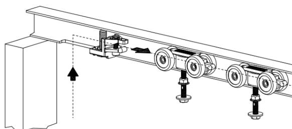
Introduire les chariots et la butée d'arrêt dans l'ouverture prévue à cet effet.
