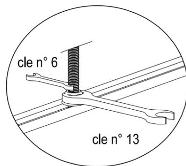
Accrocher les chariots au panneau vitré en insérant les boulons par le trou du carter. Régler le panneau par la vis avec la clé de 6 mm puis la bloquer en serrant l'écrou avec la clé de 13 mm.
