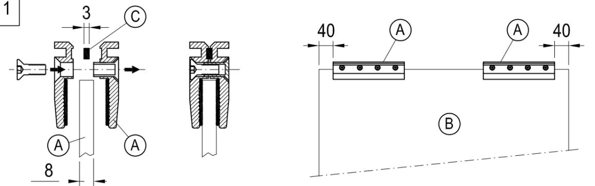
Monter les pincettes "A" pour la suspension de la porte sur la partie supérieure du panneau vitré "B" à une distance de 40 mm du bord. Vérifier la position de l'entretoise "C".
