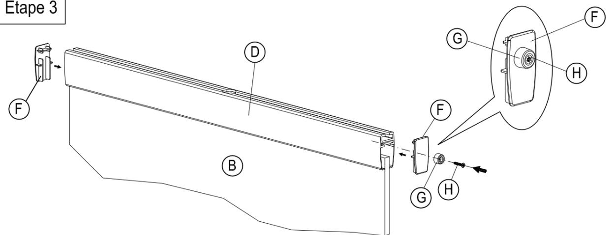
Insérer les bouchons "F" sur les côtés. Visser la butée "G" avec la vis "H" sur le bouchon postérieur "F".
