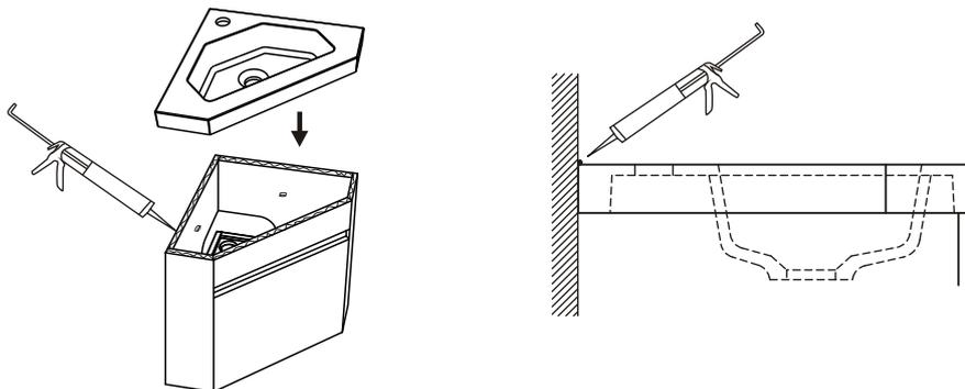
Une fois le plan posé, rajouter un filet de silicone entre le mur et le plan afin d'éviter les infiltrations à l'arrière du meuble.
