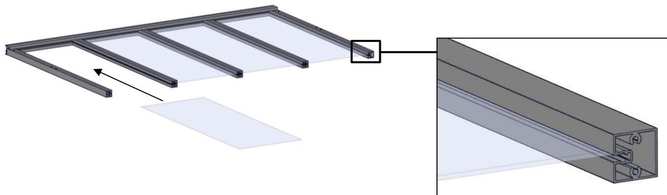
2.c. Fixer la traverse avant (traverse comportant les butées, absent sur la traverse arrière)
