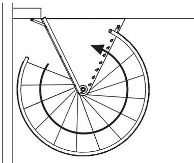
Exemple d'escalier Ø160 cm, 13 marches tournant à droite - rampe à gauche.
