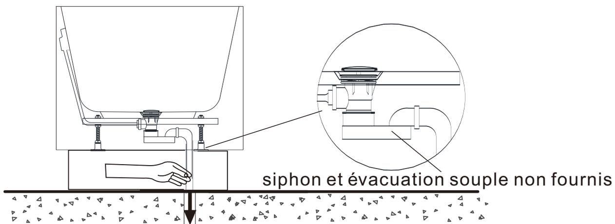
Faire couler l'eau dans la baignoire et vérifier l'étanchéité du raccord du tuyau de vidange
