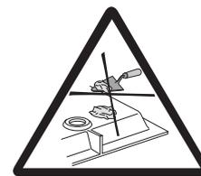
Le contact direct de plâtre ou de colle pour plaques ou carreaux de plâtre avec la sous-face du receveur est à proscrire. Il ne doit pas y avoir de blocage vertical ni latéral du receveur.
