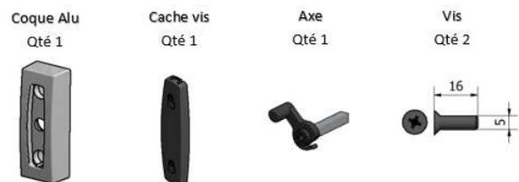
Insérez l'axe dans le boîtier crémonne (perçage central) en position ouvert, positionnez la coque alu et vissez les 2 vis dans les inserts prévus. Clippez le cache vis en mettant les cadenas en bonne position.
