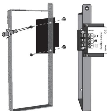
Vissez le contrôleur de charge (7) sur la bride (6) en introduisant les vis (5D) par dessous et en positionnant les écrous (5D) sur le dessus du contrôleur.
