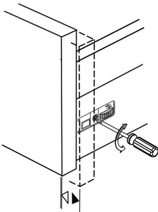
Réglage inclinaison (max.  $+ 4$  mm)
