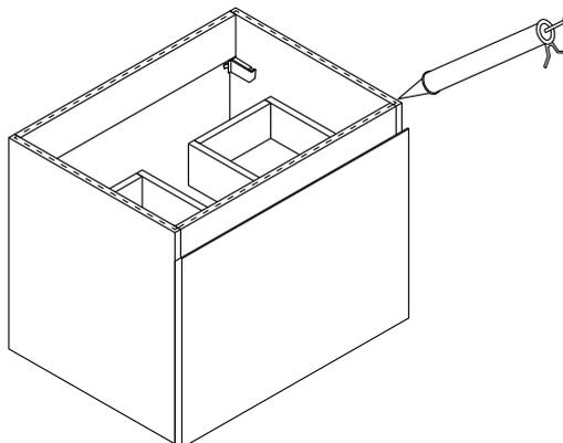
**Deuxième étape :** Appliquer un cordon de joint silicone régulier aux jonctions **plan vasque / caisson** et **plan vasque / mur**. Lisser au doigt ou à la spatule. Laisser sécher selon la durée adéquate (se référer aux données fournies par le fabricant sur la cartouche de silicone). **Ne pas mettre en eau durant cette phase de séchage.**
