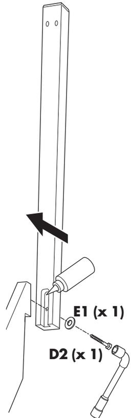
Visser le poteau d'arrivée sur la volée à l'aide du tirefond Ø 8 x 50, de la rondelle et de la clé n°13.
