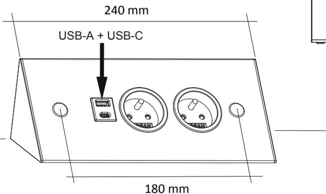
**A câbler sur un circuit de prise de courant.**
