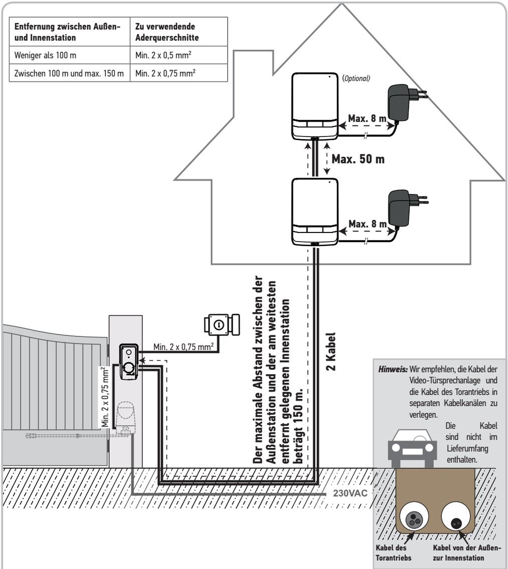
**Hinweis:** Wenn Abzweigdosen zur Verkabelung der Video-Türsprechanlage verwendet werden müssen, verwenden Sie nicht mehr als zwei Abzweigdosen zwischen Außen- und Innenstation und nicht mehr als eine Abzweigdose zwischen Innenstation und Steckernetzteil.
