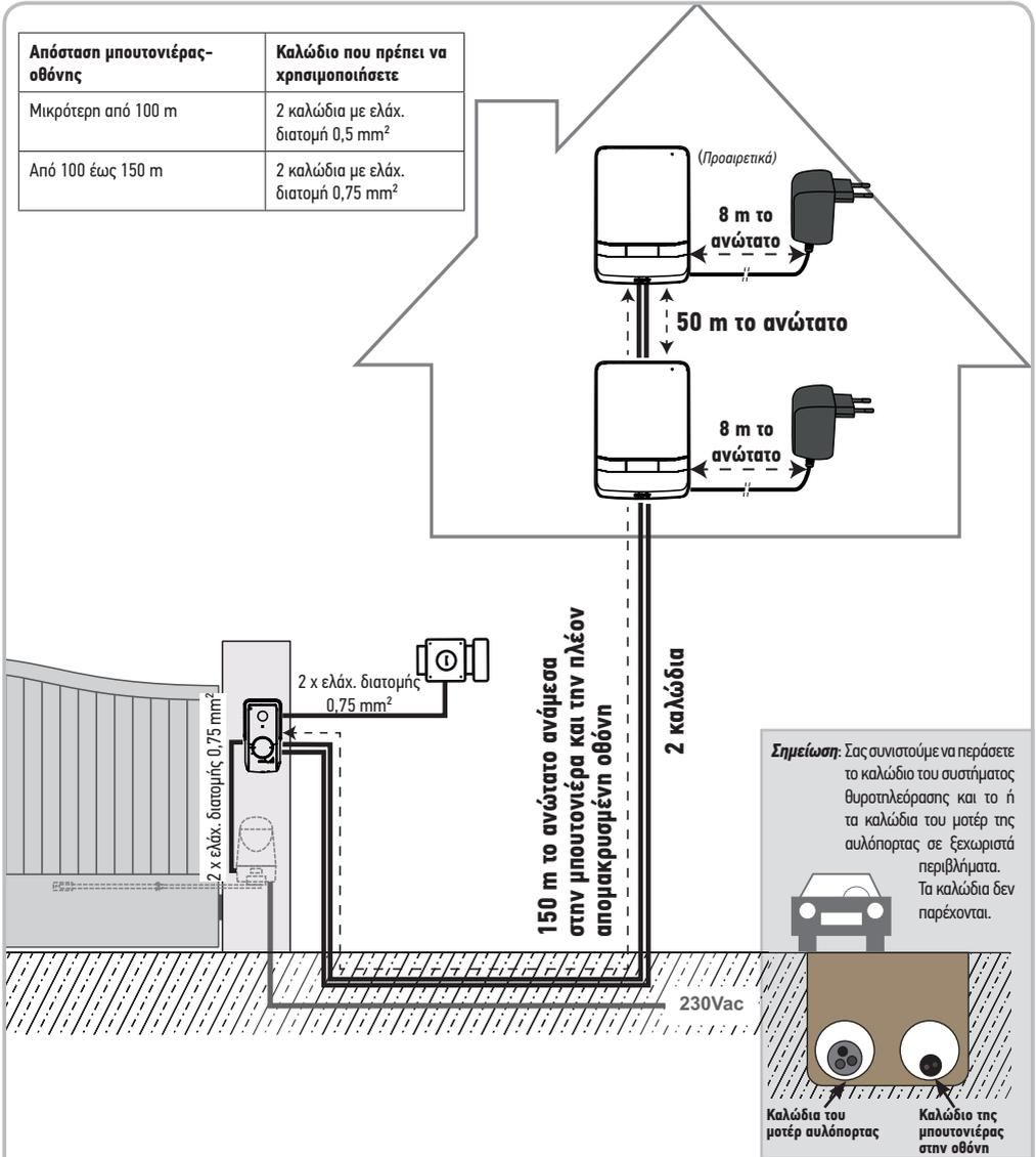
**Σημείωση:** Αν χρειαστεί να χρησιμοποιήσετε μπουτά διακλάδωσης για να συνδέσετε το σύστημα θερμοπλεόρασης, μην χρησιμοποιήσετε περισσότερα από δύο μπουτά ανάμεσα στην μπουτονιέρα και την οθόνη και όχι περισσότερα από ένα μπουτά ανάμεσα στην οθόνη και το τροφοδοτικό.
