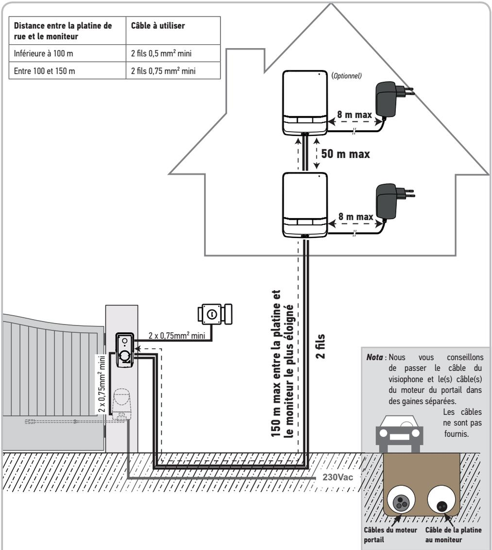
**Nota :** Si vous devez utiliser des boîtes de dérivation pour câbler le visiophone, n'utilisez pas plus de deux boîtes entre la platine et le moniteur et pas plus d'une boîte entre le moniteur et le bloc d'alimentation secteur.
