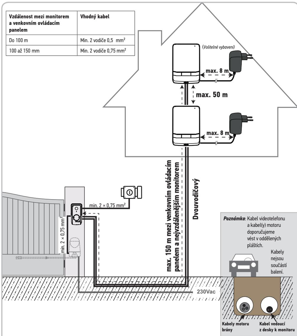
**Poznámka:** Musíte-li použít rozvodné skříně pro připojení videotelefonu, nepoužívejte mezi venkovním ovládacím panelem a monitorem víc než dvě skříně a mezi monitorem a jednotkou síťového napájení více než jednu skříně.
