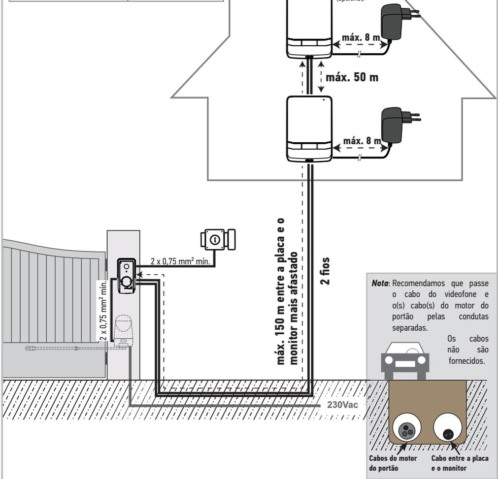
**Nota:** Se pretender utilizar caixas de derivação para ligar o videofone, não utilize mais de duas entre a placa e o monitor nem mais de uma entre o monitor e o módulo de alimentação.
