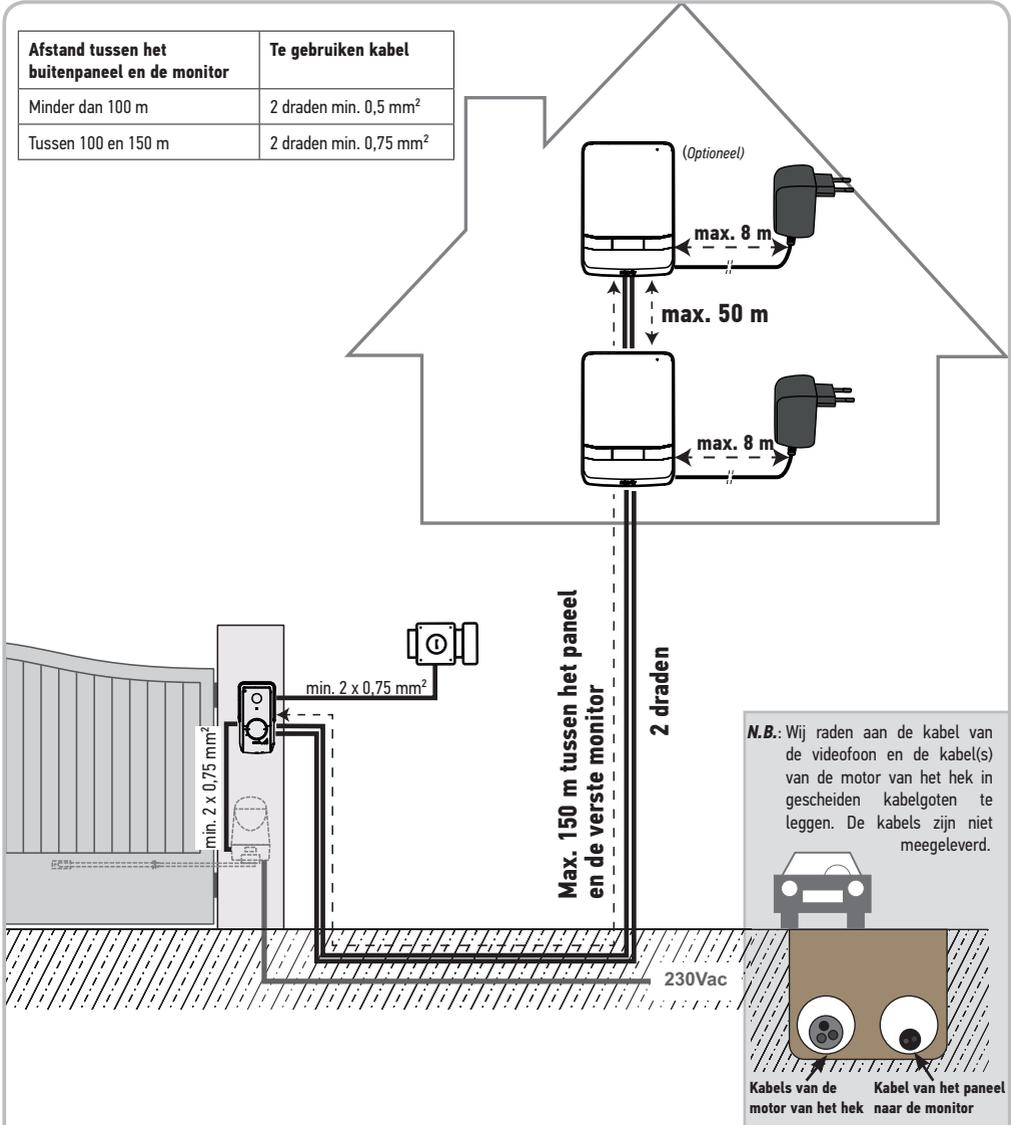
**N.B.:** Als u lasdozen gebruikt voor de bekabeling van de videofoon, gebruik er dan niet meer dan twee tussen het paneel en de monitor en niet meer dan een tussen de monitor en het voedingsblok.
