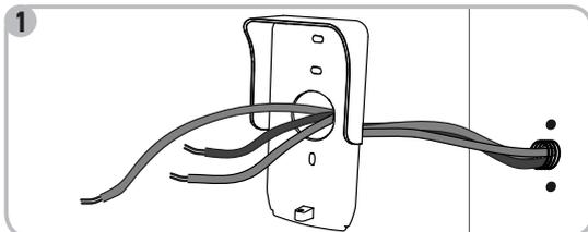
[2]. Fixe a proteção contra a chuva à parede/pilar.
