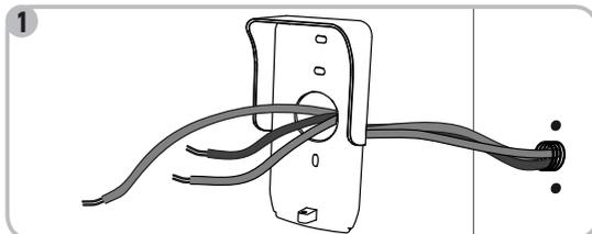
**[2].** Przymocować ostonę przeciwdeszczową do ściany / słupa.
