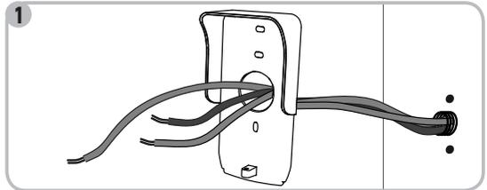
**[2].** Montieren Sie die Regenschutzabdeckung an Wand/Pfeiler.
