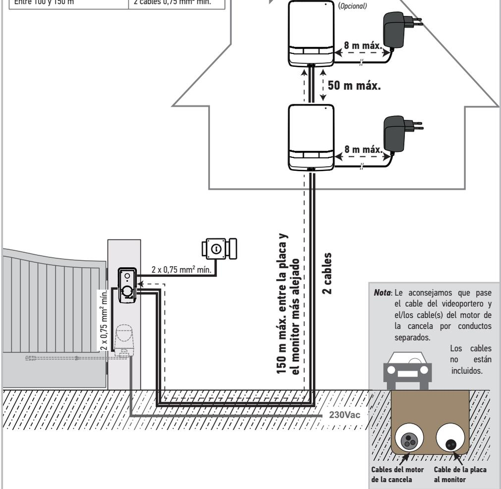
**Nota:** En caso de que deba utilizar cajas de derivación para cablear el videoportero, no utilice más de dos cajas entre la placa y el monitor ni más de una caja entre el monitor y el adaptador de corriente.
