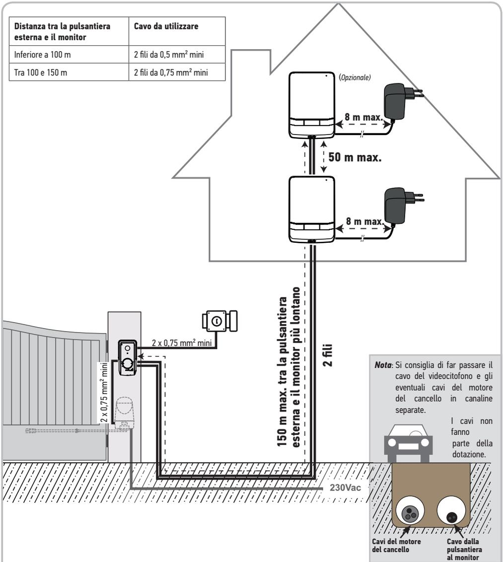
**Nota:** Se occorre utilizzare scatole di derivazione per il cablaggio del videocitofono, non utilizzare più di due scatole tra la pulsantiera e il monitor, e non più di una scatola tra il monitor e il blocco di alimentazione.
