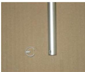
Retirer la vis qui se situe à l'extrémité du 6 pans et retirer la bague de la manivelle
