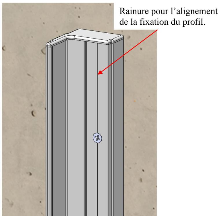
Rainure pour l'alignement de la fixation du profil.
