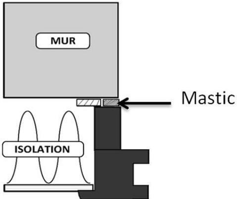
Appliquez un joint de finition au mastic dans les 5 mm restants entre la menuiserie et la maçonnerie.
