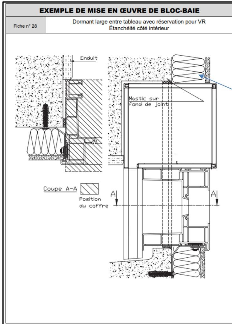
Complexe isolant autoportant ne doit pas reposer sur le coffre
