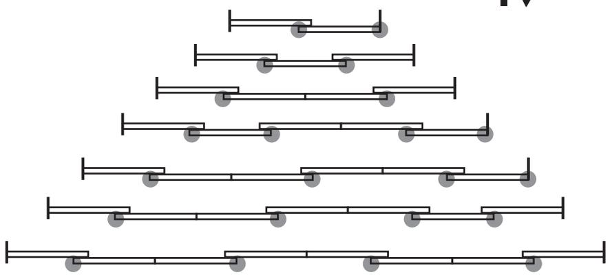
Positionner ce joint uniquement dans les montants indiqués ci-dessus
