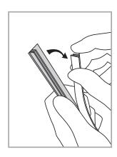
Fixer la partie arrière du profil de finition\* au mur.
