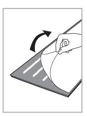
Installer la lame et **appuyer** manuellement sur toute sa surface, afin de mettre en contact complètement la colle avec le mur.
