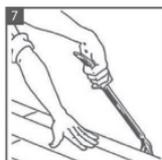
Emboîtez-les à l'aide d'un pied de biche ou d'un tire-lame, en serrant bien les assemblages.
