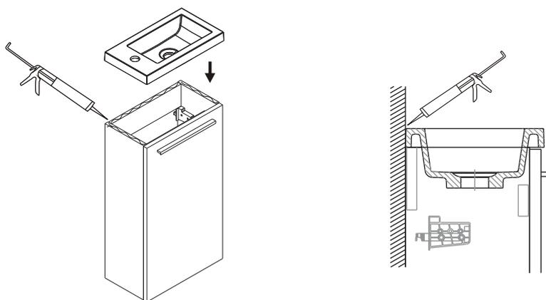
Une fois le plan posé, rajouter un filet de silicone entre le mur et le plan afin d'éviter les infiltrations à l'arrière du meuble.
