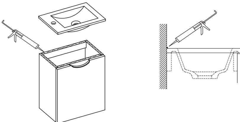
Une fois le plan posé, rajouter un filet de silicone entre le mur et le plan afin d'éviter les infiltrations à l'arrière du meuble.
