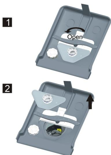
Étape 1 : tournez le filtre dans le sens inverse des aiguilles d'une montre.
