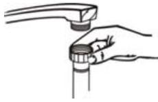
Raccordez le tuyau d'arrivée d'eau froide à un raccord fileté 3/4 et assurez-vous qu'il soit bien serré.
