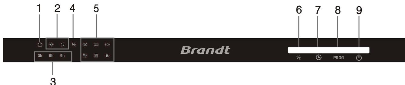
1. Indicateur d'alimentation: s'illumine lorsque l'appareil est sous tension.
