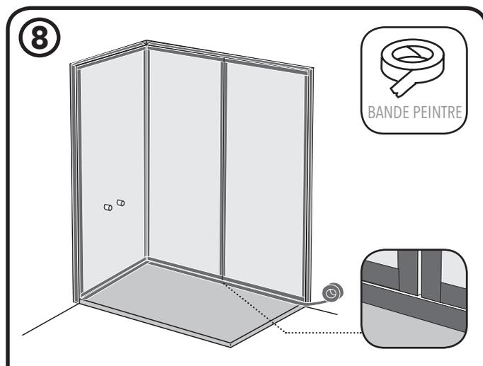
Utiliser un papier collant de masquage pour réaliser proprement l'étanchéité avec du silicone entre le panneau et le receveur et entre les panneaux.
