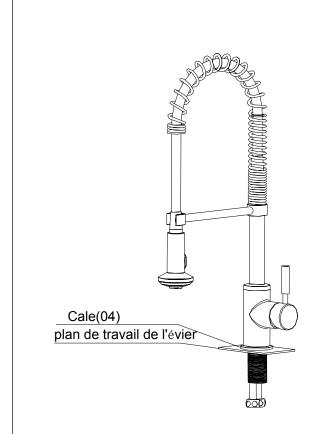
Insérer la cale (04) avec la cale de maintien (10), puis insérer le tout dans le perçage de l'évier prévu à cet effet.
