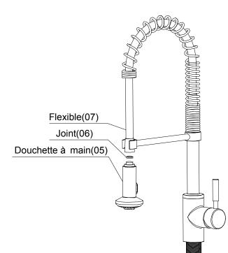
Insérer le joint (06) dans le flexible (07), puis serrer l'ensemble avec la douchette (05).
