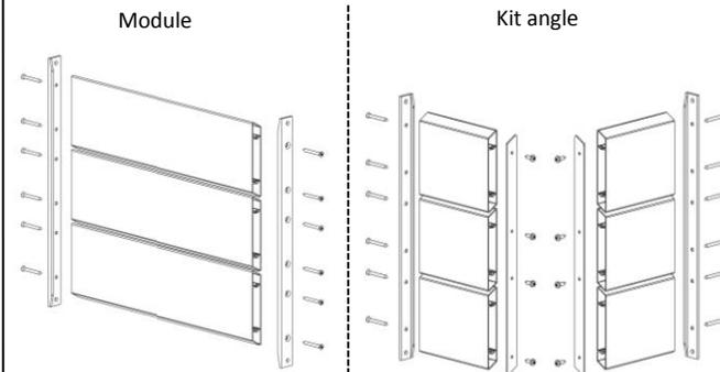
**Fixer les modules lattes sur le poteau et le kit angle**
