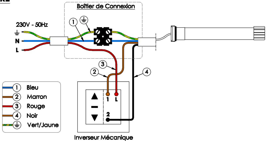
**Intervertir les Fils 3 et 4 si le moteur ne tourne pas dans le bon sens**
