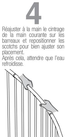
Réajuster à la main le cintrage de la main courante sur les barreaux et repositionner les scotchs pour bien ajuster son placement. Après cela, attendre que l'eau refroidisse.
