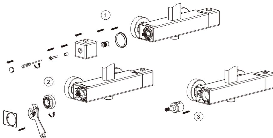
2.1 Retirez le cache-vis décoratif situé sous la poignée de l'inverseur. Dévissez la vis à l'aide d'un tournevis, dégagez la poignée puis dévissez l'écrou de verrouillage .
