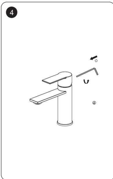
④ Visser la vis de maintien de la poignée à l'aide de la clé allen et repositionner le cache vis.
