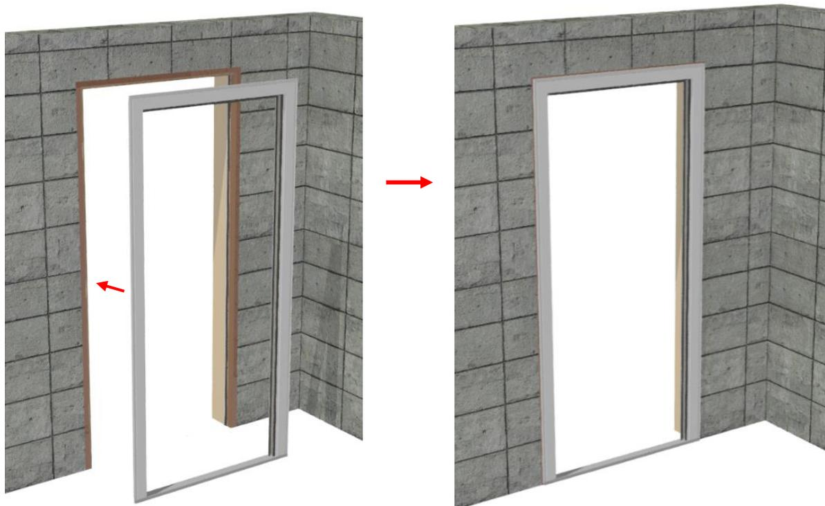
**2** Vérifier les niveaux et aplombs de la menuiserie à l'aide d'une règle et d'un niveau ainsi qu'un fil à plomb.
