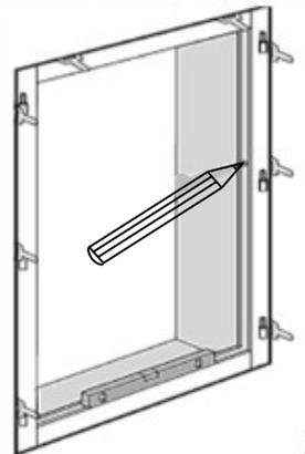
4. Pour le scellement, entaillez la maçonnerie au niveau des repérages.
