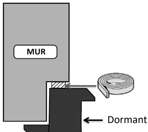
Pour un **fond de joint** : l'insérer entre la maçonnerie et la menuiserie une fois fixée.
