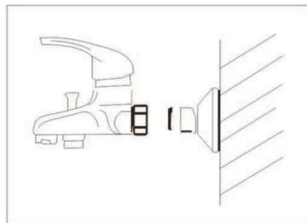
1. Encastrez vos tuyaux d'alimentations à un entraxe de 150mm (tolérance de +/-10mm). La sortie de ces tuyaux doit être au raz du mur (épaisseur carrelage compris) et en 15x21 Femelle.
