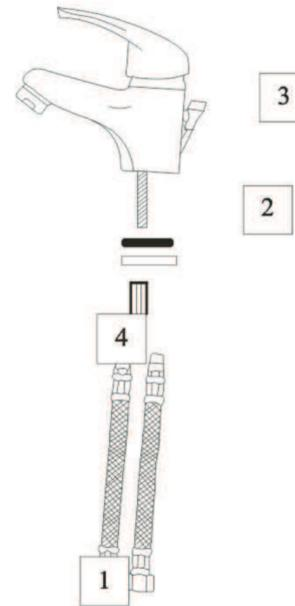
1. Vissez, à la main, les flexibles de raccordements dans le corps du mitigeur.
