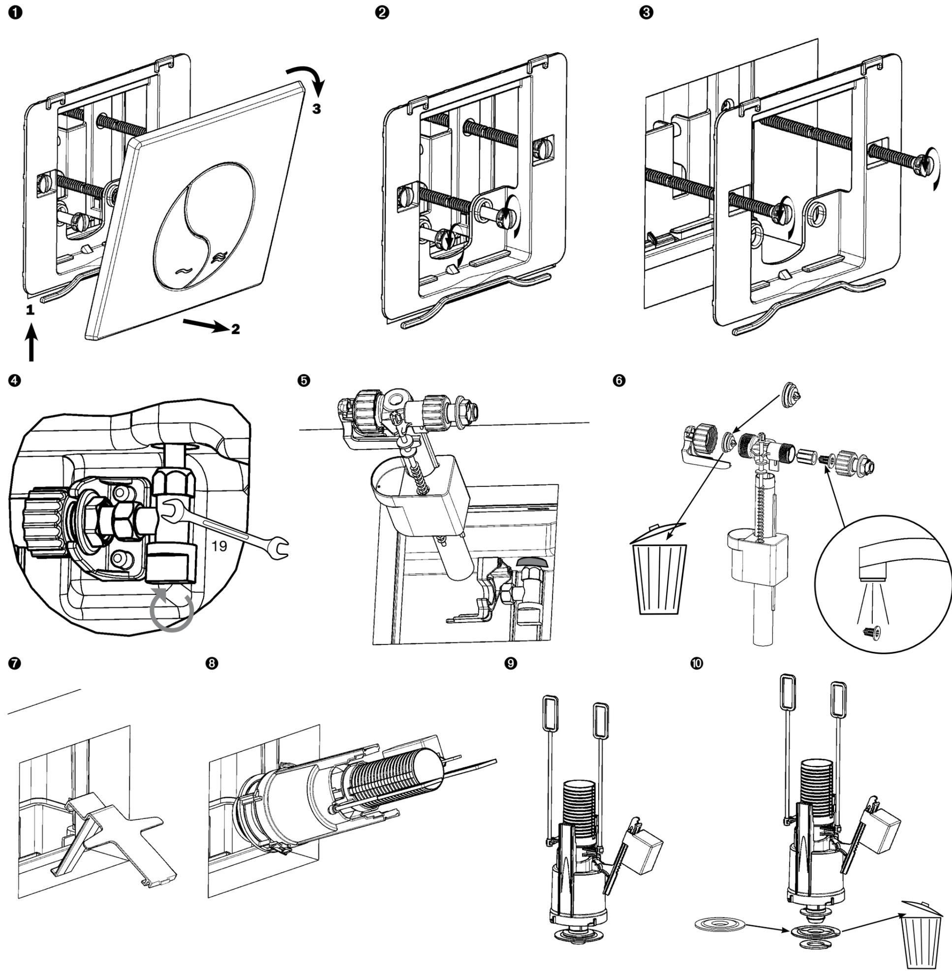
Additif réglage mécanisme de 3/6l. à 2,5/4l.
