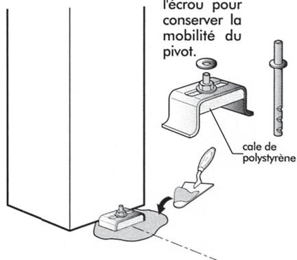
Mettez un peu de ciment dans les réservations et quelques morceaux de pierre pour renforcer la fixation. Terminez en comblant avec du ciment (**attention** à ne pas utiliser de ciment prompt pendant les périodes de gel). **LAISSEZ SÉCHER 24 H**
