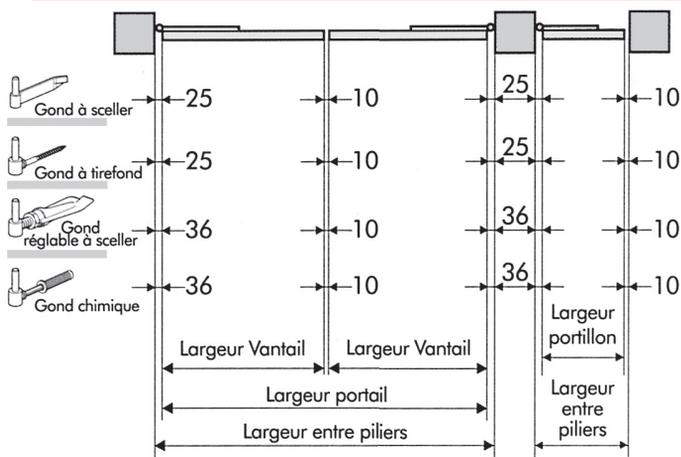
▲ **CAS SPÉCIFIQUE : Pose entre piliers avec penture équerres et piliers parfaitement d'aplomb.**
