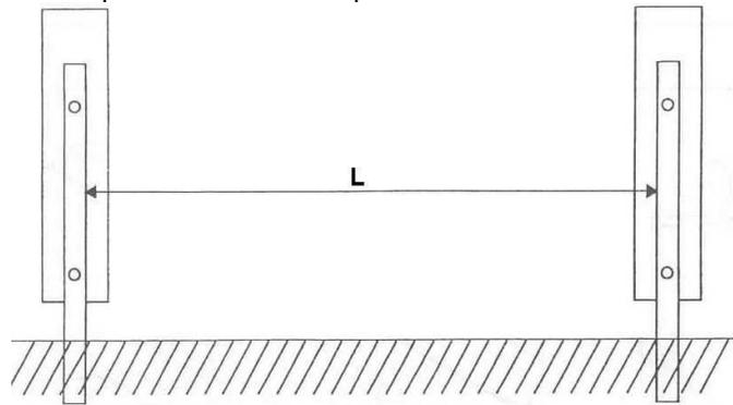
L : largeur des traverses horizontales de la travée + 12 mm
