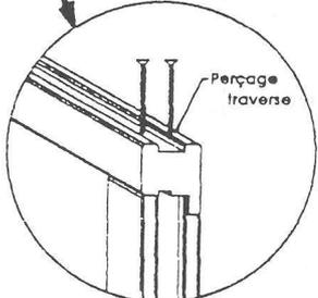
Le couvre joint sert de cale de jeu ①. Il doit être enlevé après la pose ② pour être fixé comme prévu en ③
